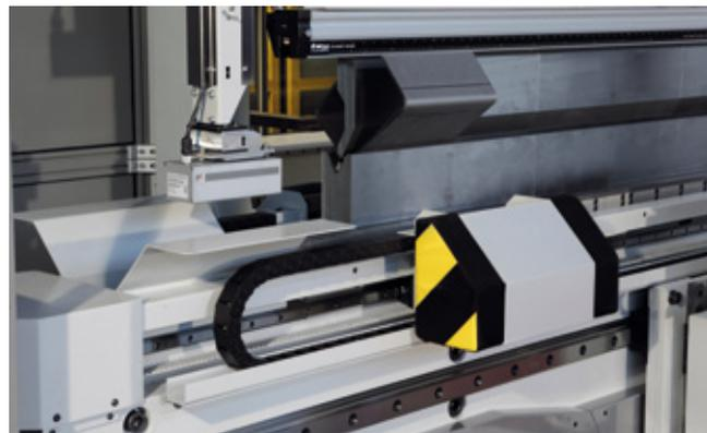
■ Il sistema "COPRA LASER CHECK - DATA M" controlla e corregge l'angolo di piega consentendo di ottenere tolleranze minime fin da primo pezzo del nostro lotto di piegatura. Il sistema permette alla macchina di adattarsi alle variazioni di spessore, resistenza del materiale e compensa le variazioni risultanti dai diversi sensi di laminazione.
