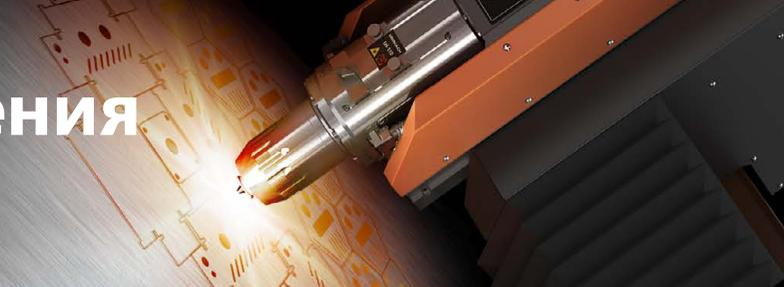
Система автоматического слежения за поверхностью листа FoCut является наиболее производительной из аналогичных систем, представленных на рынке. FoCut обеспечивает стабильность удержания оптической головки с точностью до 0,05 мм в широком диапазоне высот, что позволяет четко работать даже на сильно деформированном металле, а также на краях заготовки. Высокая скорость измерения (100 кГц) обеспечивает минимальное время реакции системы слежения.
