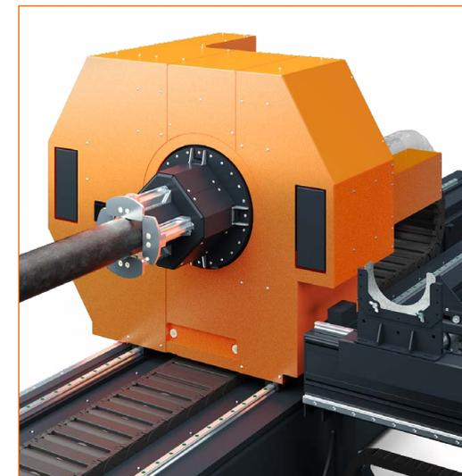
Автоматический захват для прямоугольной и круглой трубы
