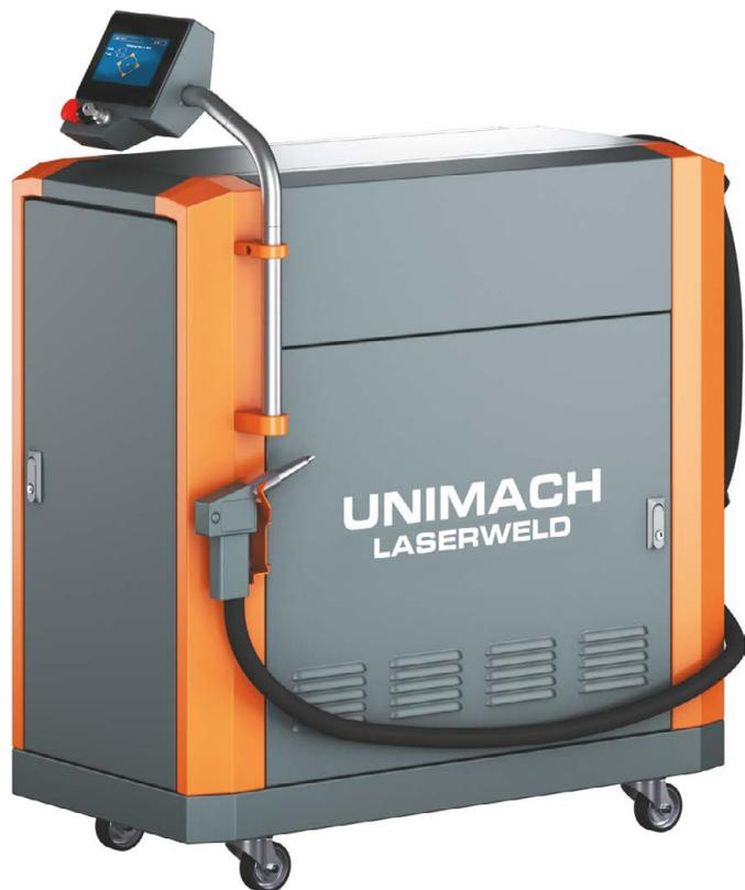
Аппарат LaserWeld для лазерной сварки изделий из металла – новейшая разработка в области сварочных технологий. Предназначен для сварки стыковых, угловых, тавровых и кольцевых швов, а так же для сварки плохо подогнанных изделий (с использованием устройства подачи проволоки).
